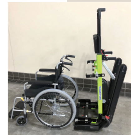
①平坦な場所で受け台を広げ、キャスターをロックします。 ②車輪幅に合わせてロックします。
