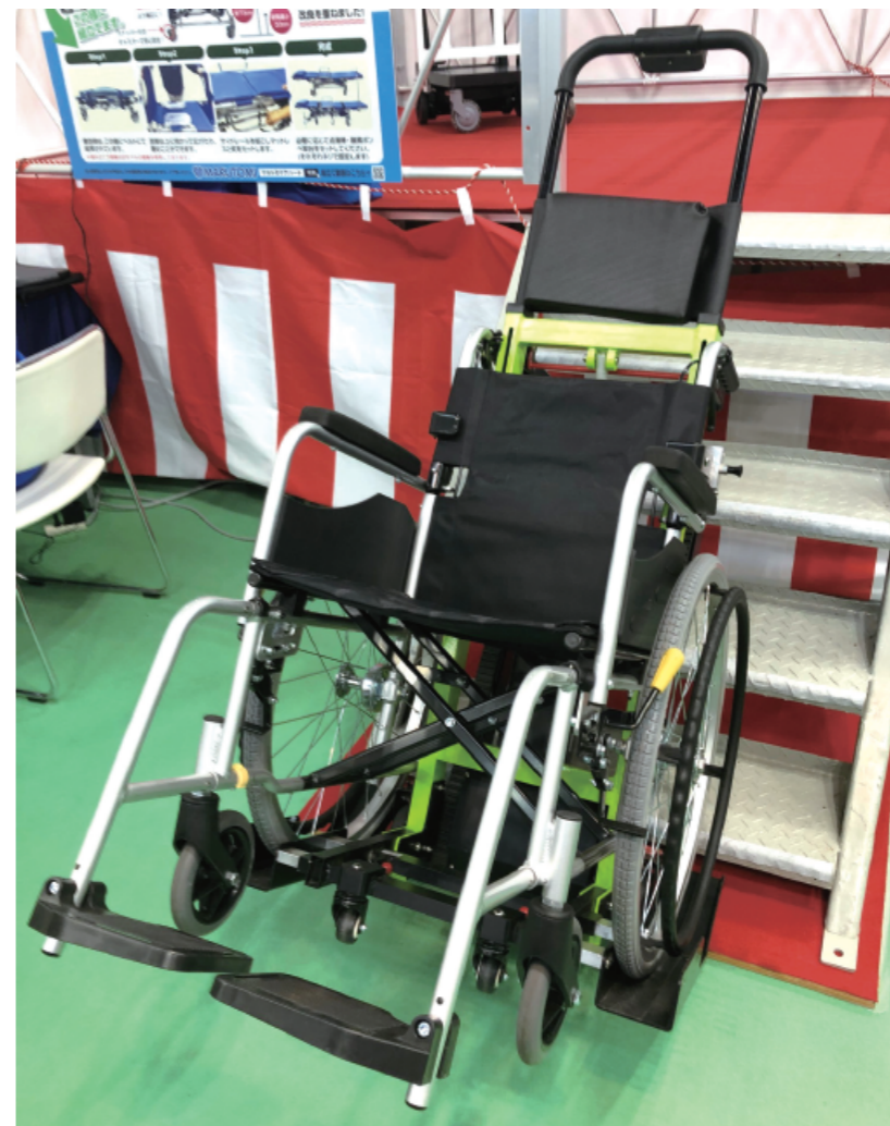
強いグリップ力のクローラー仕様のため、階段途中で止まっても滑り落ちません。安心安全のストッパー付キャスターであるため安心設計です。
