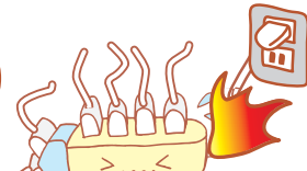
接続可能な最大消費電力を超えて使用する
