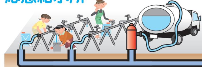
配水池から専用のパイプで繋がっていて、災害時に断水が発生した場合に臨時的な応急給水所となります。またタンク車に給水するための大型の給水栓も設置されています。
