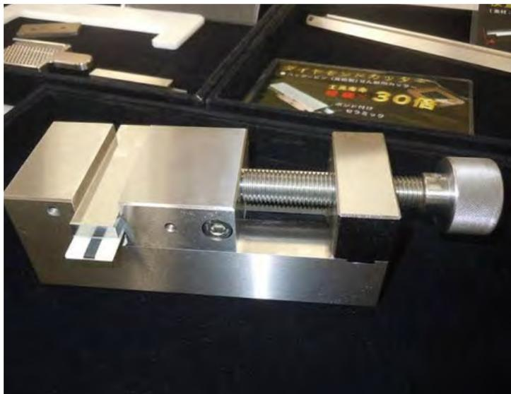
上の写真は精密バイスと言い、製造工程において対象物を固定し位置決めを行い、検査工程で基準となる治具です。治具は作業効率や製品の完成度を大きく左右し、モノづくりに欠かせません。また産
