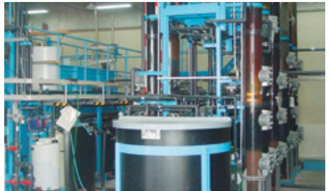
加納浄水場に設置した実験プラントで、紀の川の水質の変化に対応した、より適正な浄水処理を行うためのデータを蓄積しました。
