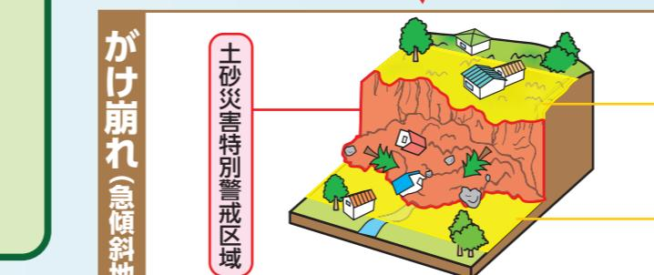
地面にしみ込んだ水分により、急な斜面が突然崩れ落ちる現象です。突然起きたため、家の付近で起きると逃げ遅れる人も多く、死者の割合も高くなります。
